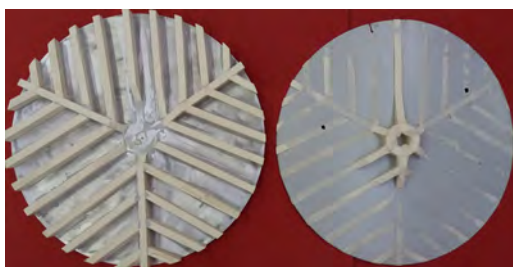
Fig. 4d. core shear (MEC 2)
